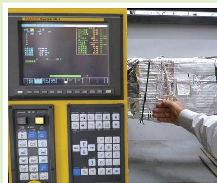
プラスチック成型機の配管部分には、アルミ製品が巻きつけてある。「熱効率を上げるために、近所のお店で買って取り付けました」と、阿部社長は自分なりの工夫で省エネ対策をしてきた
