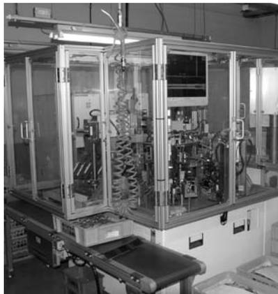
エンジンプラグ用部品の検査装置
