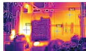
燃焼炉筐体温度分布 (高温部280℃) 表面温度分布を画像で表示できるサーモビューアによる、燃焼炉筐体温度分布。
